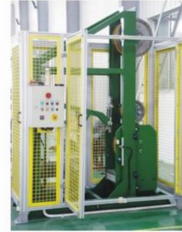
Rope fatigue life testing machine 钢丝绳弯曲疲劳试验机
