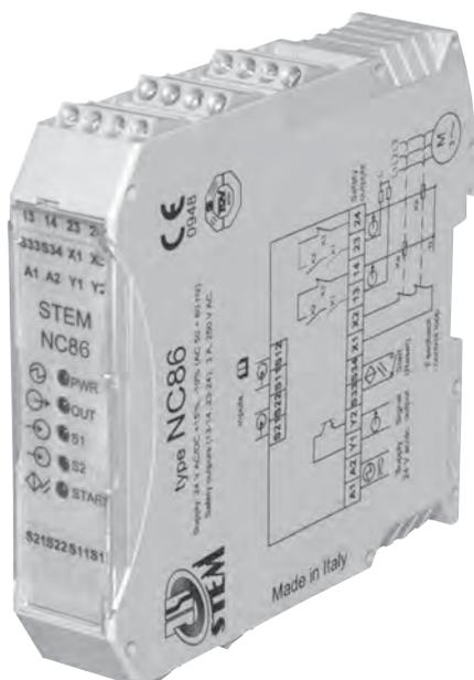
La centralina di sicurezza NC85 è in grado di controllare lo stato di due sensori magnetici Reed: l'uscita viene attivata premendo il pulsante di START solo se i contatti dei due sensori risultano chiusi.
