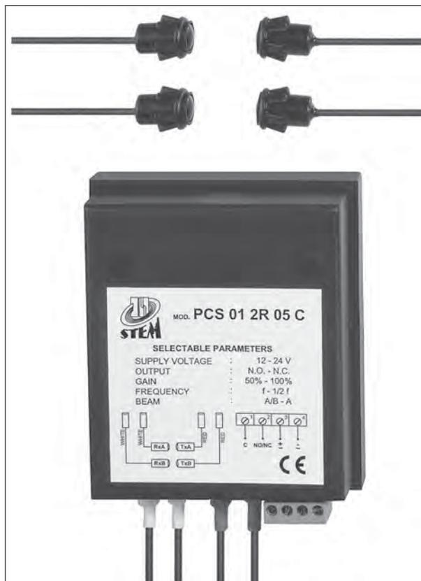
La STEM è in grado di proporre anche fotocelle con modulo di interfaccia esterno a relay. Possono essere alimentate con tensione continua o alternata a 12 o 24 V e prevedono un'uscita N.O. o N.C. con contatto a relay. Sono disponibili due versioni:
